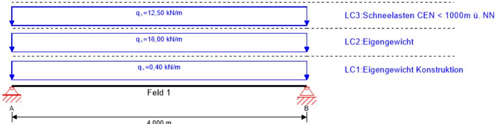
**Querschnitt:** Holzträger 20/40; **Material:** GL 24h; **Nutzungsklasse:** Nutzungsklasse 1; **Feuerwiderstandsklasse:** R 30
