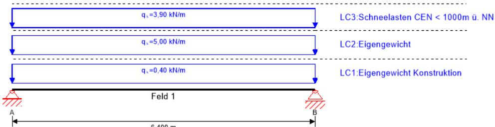
**Querschnitt:** Holzträger 20/40; **Material:** GL 24h; **Nutzungsklasse:** Nutzungsklasse 1; **Feuerwiderstandsklasse:** R 30
