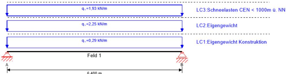
**Querschnitt:** Holzträger 18/32; **Material:** C24 Nadelholz; **Nutzungsklasse:** Nutzungsklasse 1; **Feuerwiderstandsklasse:** R 30
