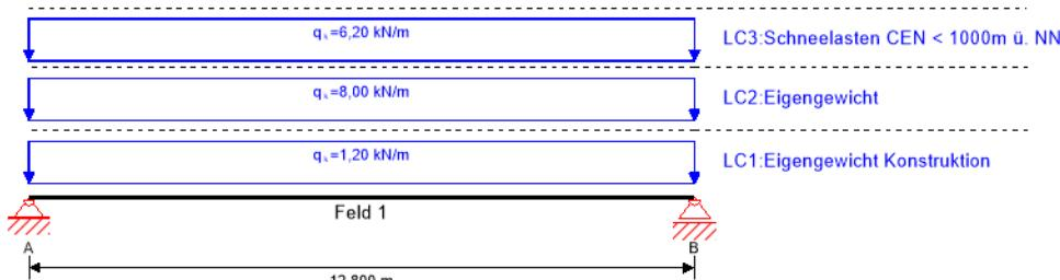
**Querschnitt:** Holzträger 30/80; **Material:** GL 24h; **Nutzungsklasse:** Nutzungsklasse 1; **Feuerwiderstandsklasse:** R 30
