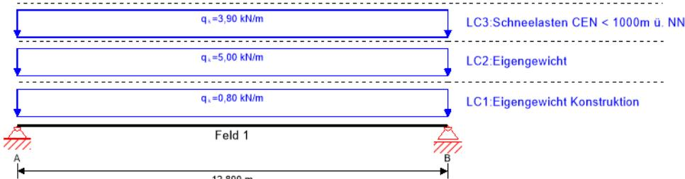
**Querschnitt:** Holzträger 20/80; **Material:** GL 24h; **Nutzungsklasse:** Nutzungsklasse 1; **Feuerwiderstandsklasse:** R 30
